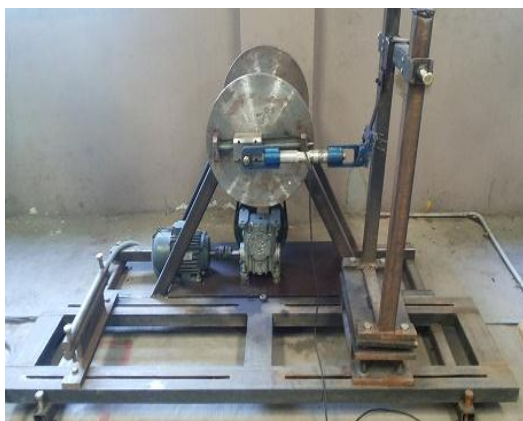
Fig: Actual Flexural fatigue test rig
